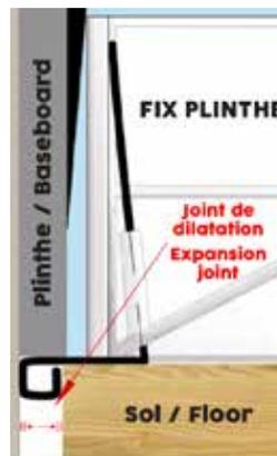
4) Pour bloquer la plinthe en pression, il suffit de rajouter une ou plusieurs cales crantées noires entre le mur et le FIX PLINTHE® suivant la pression à exercer. Ce dispositif maintient efficacement la plinthe en pression pendant tout le temps de séchage de la colle.
